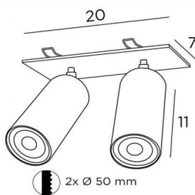
Deux spots LED sur plaque rectangulaire, à encastrer, douilles GU10 - 230V et possibilité d'y placer des ampoules de très grande puissance
