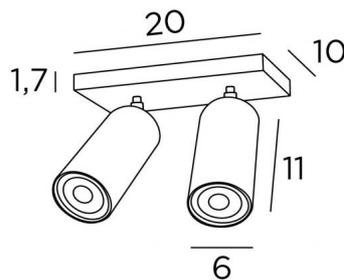
Deux spots LED sur base rectangulaire avec douilles GU10 (230V). Possibilité d'y placer des ampoules de très grande puissance
