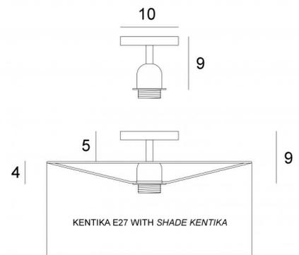
Suspension avec une douille E27 pour y placer tout abat-jour muni d'une attache E27
