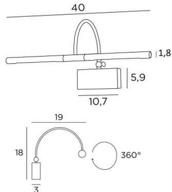
Eclairage de tableau sobre, discret mais efficace. Le col de cygne est inclinable au moyen d'une petite rotule avec clé. Ce modèle existe en 3 tailles.
