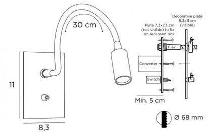
Petite liseuse avec flexible et spot LED sans vis apparentes à placer près d'un lit. Convertisseur à placer dans une boîte à encastrer standard placé à l'arrière. Minimaliste mais efficace, elle diffuse une lumière chaude et concentrée.
