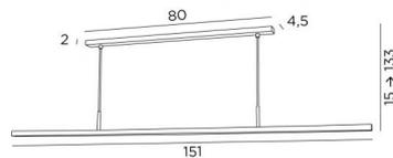
Suspension avec réflecteur fixe et module LED intégré sans convertisseur et dimmable. Lumière chaude. À placer au-dessus d'un bureau, d'une table ou d'un plan de travail. Existe en 3 tailles
