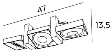
Plafonnier avec trois spots prévus pour ampoules Ø111mm (AR111 - 12V). Existe avec 1, 2 ou 4 spots. Possibilité d'y placer des ampoules LED de grande puissance
