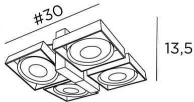
Plafonnier avec quatre spots prévus pour ampoules Ø111mm (AR111 - 12V). Existe avec 1, 2 ou 3 spots. Possibilité d'y placer des ampoules LED de grande puissance
