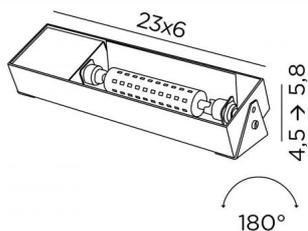
Uplight, éclairage indirect puissant, à placer en invisible dans un rail ou dans le haut d'un muret, d'un meuble ou une poutre
